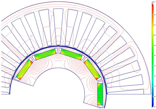
Figure 6- Demagnetisation Analysis Using FEA
